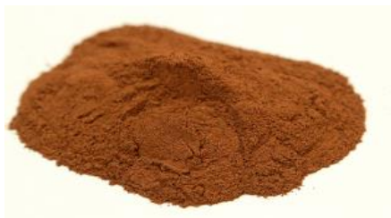
Fig. 1. Ash obtained after fluidized-bed combustion of sewage sludge Rys. 1. Popiół uzyskany po fluidalnym spalaniu osadów ściekowych
