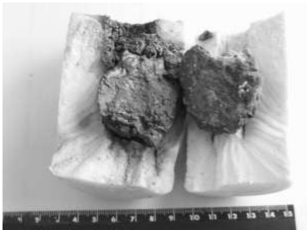
Rys. 3. Sztuczne zanieczyszczenia zatrzymane przez wkład filtrujący
